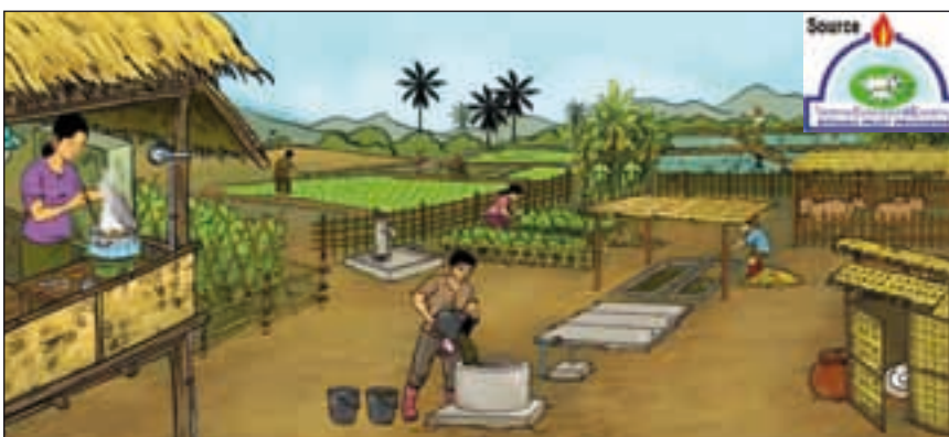
Bild 3: Schema der Nutzung der Kleinbiogasanlagen (4–12m 3 Behältervolumen), wie sie im Rahmen des Biogas Pilot Program in Laos eingesetzt werden
